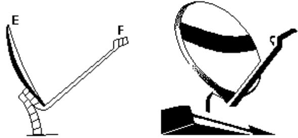
a) Copie o esquema da figura da esquerda e represente o traçado da radiação eletromagnética proveniente do satélite retransmissor que incide no refletor E e se reflete, convergindo para o foco secundário F (faça um traçado semelhante ao traçado de raios de luz). Coloque nessa figura uma seta apontando para a posição do satélite.
