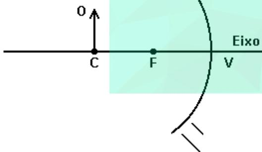
A figura representa um objeto O colocado sobre o centro de curvatura C de um espelho esférico côncavo. A imagem formada será
