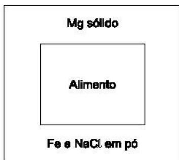
Para o aquecimento do alimento, introduz-se água no recipiente externo, através de orifício próprio. Em presença de Fe e NaCl, a reação
